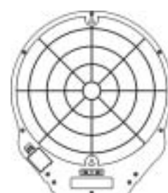
Odšroubujte dolní kryt terče a otevřete ho.
