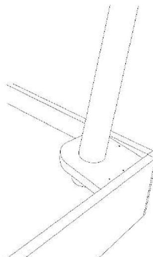
IT – Posizionare prima l'angolare di sostegno e poi avvitare la gambe nell'apposita sede. Successivamente fissare con 4 viti l'angolare.
